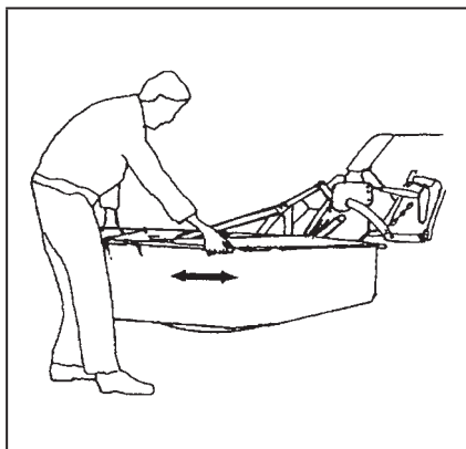
Rys. 9. Sposób obrotu kosiarki w czasie zmiany położenia z transportowego w robocze i odwrotnie.
